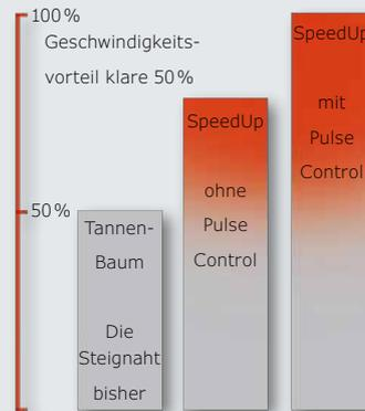
Der konzentrierte SpeedUp-Lichtbogen ist mit der neuen Lorch S-XT bis zu 100 % schneller bei Stahl und Edelstahl als das herkömmliche Tannenbaumschweißen.
