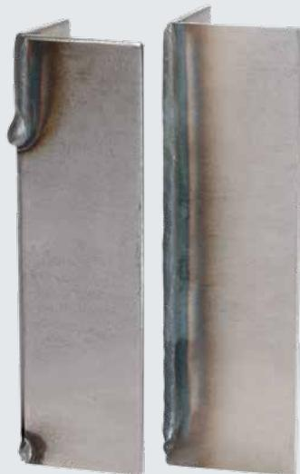
Im Bild links eine geschweißte Ecknaht im Vergleich.
