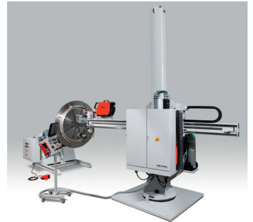
Auch für individuelle Kundenwünsche findet HABA HÄHNLE eine Lösung. Hier zu sehen ist ein Automatenträger mit Drehkipptisch. Fotos: HABA HÄHNLE
