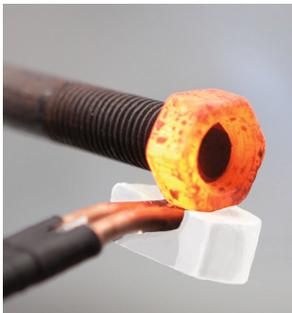
Lösen von Bolzen
