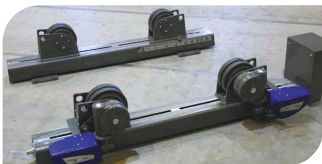
PEMA N12-Rollenbocksatz, Antrieb und Leitrolle
